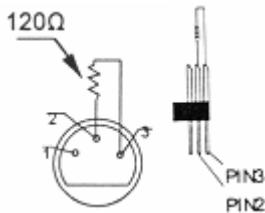
Een DMX eindweerstand is aanbevolen als de DMX-kabel vrij lang is of wordt gebruikt in een omgeving met veel elektrische ruis (bv. een discotheek). De eindweerstand voorkomt corruptie van het digitale controlesignaal door elektrische ruis. De DMX eindweerstand is niets meer dan een XLR-stekker met een weerstand van 120 Ω van pin 2 naar 3. Deze XLR-stekker wordt dan aangesloten op de XLR-uitgang van het laatste toestel in de reeks.
