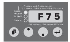
Fig. 12: Adjusting the fan
