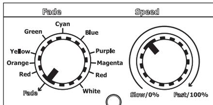
Ce mode permet un changement de couleur automatique du ruban. Amenez le bouton Fade/Color sur la position Fade et ajustez la vitesse d'enchaînement des couleurs avec le bouton Speed/Dimmer.
