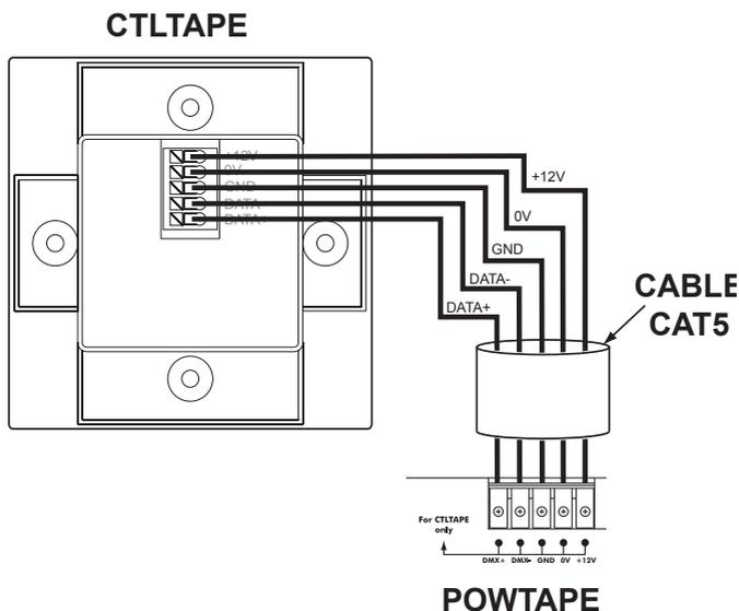
**Note :** Un câble réseau CAT5 comporte 8 conducteurs plus la masse, dans le cadre de l'utilisation avec le système POWTAPE/CTLTAPE, la masse et trois conducteurs ne seront pas utilisés. Coupez les conducteurs non utilisés pour éviter qu'ils ne provoquent des courts circuits.
