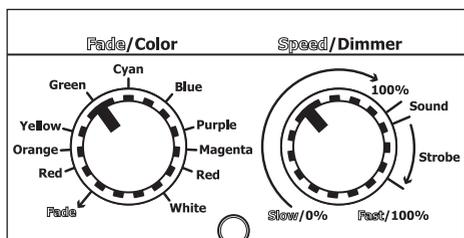
Ce mode permet de sélectionner une couleur précise. Amenez le bouton Fade/Color sur la couleur de votre choix (Vert dans l'exemple ci-contre) et ajustez l'intensité avec le bouton Speed/Dimmer sur la plage 0 à 100%. Sur la position «**Sound**», les programmes internes du POWTAPE sont activés par le son. Sur la position «**Strobe**» le ruban à LED clignote. Le clignotement s'effectue de plus en plus vite sur la couleur choisie.
