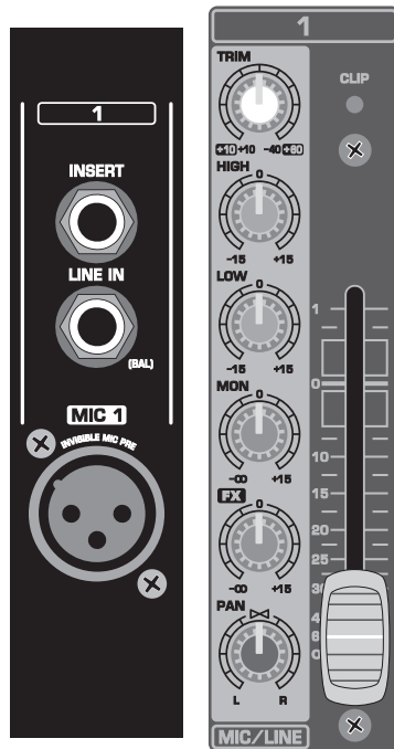
Afb. 2.1: De aansluitingen en regelaars van de monokanalen
