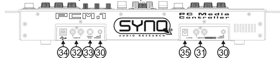
30. **FADER START:** bei Benutzung mit einem externen Mischer, können Sie diesen Ausgang mit dem Fader Start-Eingang Ihres Mixers verbinden, um die Start/Stop-Funktion des Players von Ihrem Mischer zu regeln. (Achtung: funktioniert nur mit Pioneer®/SynQ® kompatiblen Mixern)
