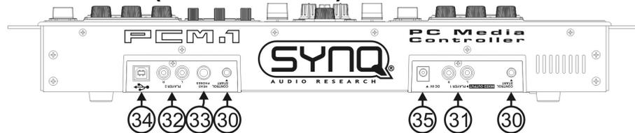
**30. Connexion pour FADER START**: quand on travaille avec un mixer externe, on peut raccorder cette sortie à l'entrée 'fader start' de ce mixer afin de contrôler la fonction 'start/stop' d'un lecteur depuis le mixer externe. Attention : ce dispositif ne fonctionne qu'avec des mixers compatibles Pioneer®/SynQ®)
