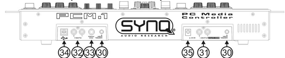
30. **FADER START (inicio de fader):** cuando se utiliza con una mesa de mezclas externa se puede conectar esta salida con al entrada de inicio de fader de la mesa de mezclas para controlar la función inicio/parada del reproductor desde la mesa de mezclas. (**Atención:** sólo funciona con la mesa de mezclas Pioneer®/SynQ® compatible)
