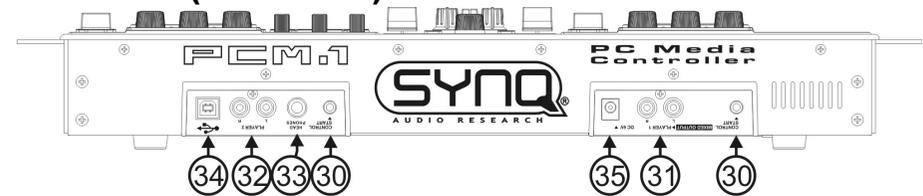
30. **FADER START:** quando usado com uma mesa externa pode conectar esta saída com a entrada fader start da vossa mesa para controlar a função iniciar / parar do leitor a partir da mesa. (**atenção:** funciona apenas com mesas compatíveis Pioneer®/SynQ®)
