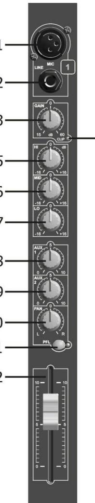
**STEREO LINE EINGANGS KANAL****1. LINE EINGANG LINKS ODER MONO**
