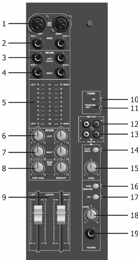
uitgangsmix. (Gebruik in samenwerking met linkerniveau (6) wanneer u een mono ingangssignaal mixt)
