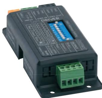
Compatible avec les gammes COLORTAPE et PURETAPE, ce module convertit vos instructions DMX ou manuelles en signal d'alimentation pour vos rubans. Combiné à une alimentation adaptée, il peut commander un ruban tricolore ou jusqu'à trois rubans monochromes.
