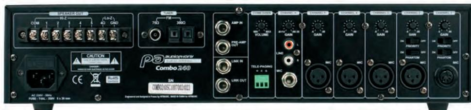
Vue sur la plaque de connexion arrière du COMBO240
